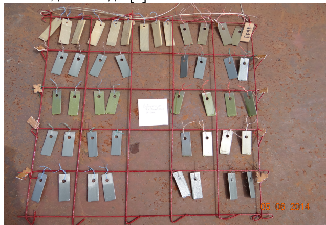
Фото 1. Общий вид установки для экспонирования субстратов в воде на Каневском водохранилище, дата установки стенда 5.06.2014
