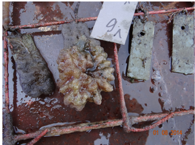
Фото 2. Общий вид экспериментальных субстратов с покрытием ПУ-лак УР-167+Zn+антисептик1234 при 57-суточной экспозиции на Каневском водохранилище, 2014 г. На одной из пластин отмечена крупная колония мшанки Hyallinella punctata Jullien
