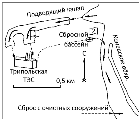
Рис. 2.36. Схема системы водоснабжения Трипольской ТЭС
