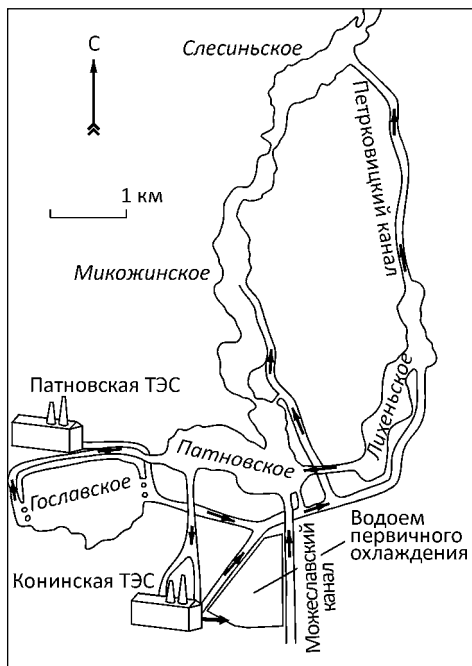
Рис. 2.25. Схема системы охлаждения Конинской (КТЭС) и Патновской (ПТЭС) тепловых электростанций
