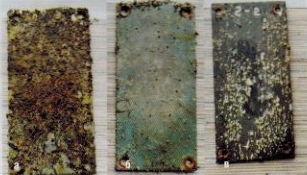
Рис. 4. Образцы покрытий после испытаний (Белое море, июль-сентябрь 2015 г.): а) алюминиевая пластина без покрытия (контрольный образец); б) каучук-эпоксидное противообрастающее покрытие; в) промышленная судовая краска Тiйх 33 (образатели — мидии практически отсутствуют, однако заметны следы взаимодействия компонентов краски с морской водой)
