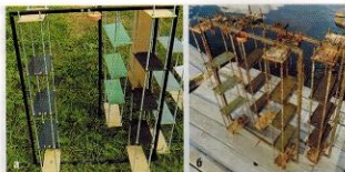
Рис. 3. Стенды с образцами противообрастающих покрытий до (а) и после (б) испытаний. Белое море июль/сентябрь 2015 г.
