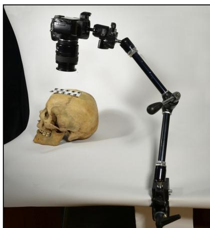
**Рис. 3.** «Рука»: кронштейн шарнирный Manfrotto 143A Magic Arm с креплением для камеры с шаровой головкой.
