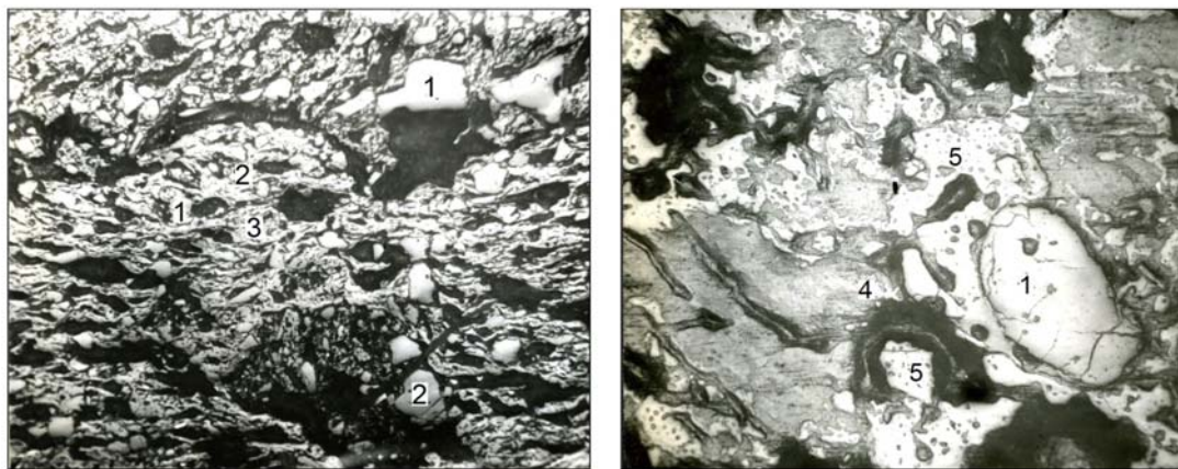
Рис. 7. Фотографии микроструктур глиняных тиглей (увел. 70): 1 — включения кварца; 2 — включения полевого шпата; 3 — стекловещество метакаолинит с оксидами железа FeO, Fe 2 O 3 ; 4 — корольки меди; 5 — включения Cu 2 O
