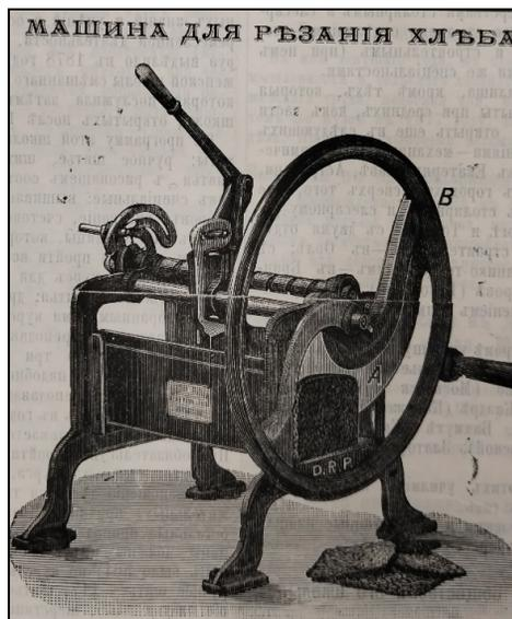
**Рис. 2.** Механическая машинка для резания хлеба [Машина для резания хлеба..., с. 1].
